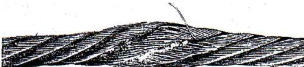
h) Formación de cocas.: Los cables con UNA (1), o más cocas deben ser desechados. Se generan a partir de estirar un cable que presentaba un lazo en forma de argolla, sin que el cable pudiera compensar la deformación, girando sobre su eje.
