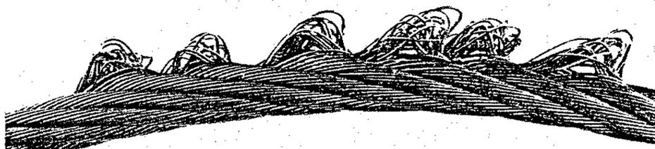
d) Aflojamiento de algunos alambres o cordones: Cuando su origen se deba a corrosión o desgaste, el cable deberá ser desechado. El aflojamiento provoca que alambres exteriores del cable cargado o algunos cordones individuales sean desplazables, por tal razón se sobrecarga el resto de los alambres o cordones.
